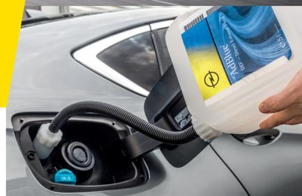
Der 1,6-Liter-Dieselmotor im Opel Insignia verfügt ab sofort über hochmoderne Technologien, die ihn bereits jetzt für die ab September 2019 obligatorische Abgasnorm Euro 6d-TEMP wappnen. Hauptbestandteil ist eine SCR-Regelung mit AdBlue-Einspritzung. Der in AdBlue enthaltene Harnstoff reduziert die Stickstoffoxide (NOx) im Abgas markant, weshalb entsprechend ausgerüstete Fahrzeuge von einem möglichen Diesel-Fahrverbot in Städten nicht betroffen sein werden.
